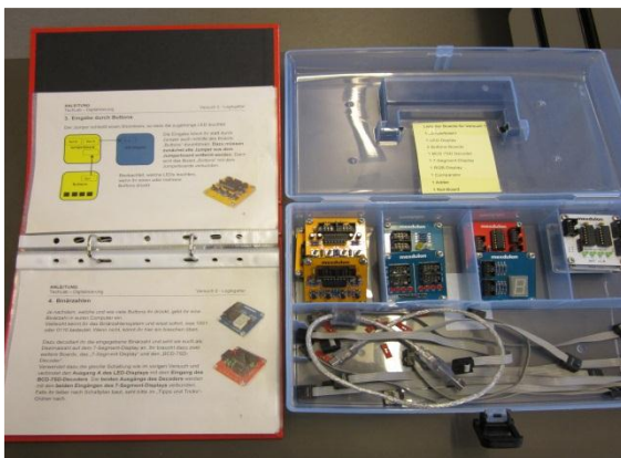
Baukasten und Anleitung für Station 1 "Binärzahlen und ihre Verarbeitung"
