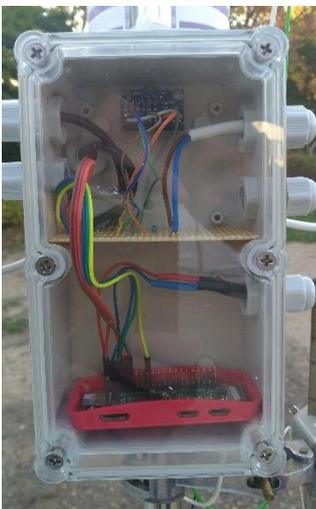
Abb. 2: Das „Gehirn“: der Raspberry Pi Zero mit Platine für die Messelektronik
