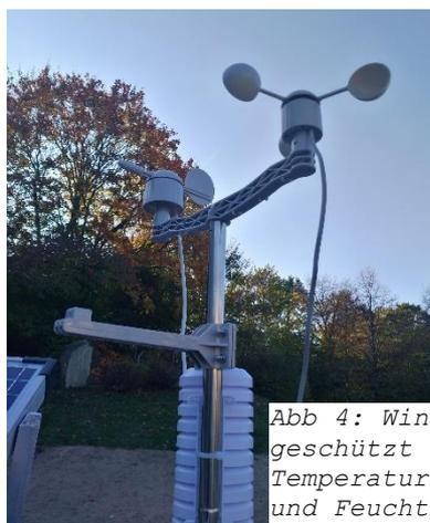
Abb 4: Windsensoren sowie geschützt im Gehäuse, Temperatur-, Luftdruck und Feuchtigkeitssensor
