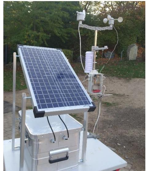
Abb 1: Wetterstation mit Energiemodul im Testbetrieb auf dem Schulhof
