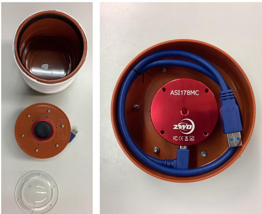
**Abbildung 1:** All Sky Kamera in Einzelteilen (links), innenseitige Ansicht der Kamera in dem Muffenstopfen (rechts)
