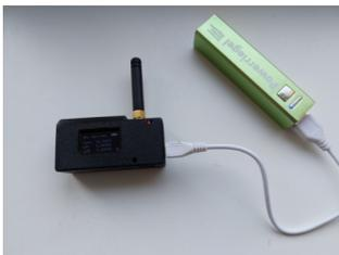
Mit einem ESP32-Controller und einer Antenne versuchen wir, Wettersonden im Anflug auf unsere Region zu orten. In Schaubild 1 ist die eingesetzte mobile Empfangsstation zu sehen. Die Station verbindet sich über ein eigenes WLAN mit dem Smartphone, auf dem eine App läuft, die die Daten empfängt und uns zur Sonde leitet.
