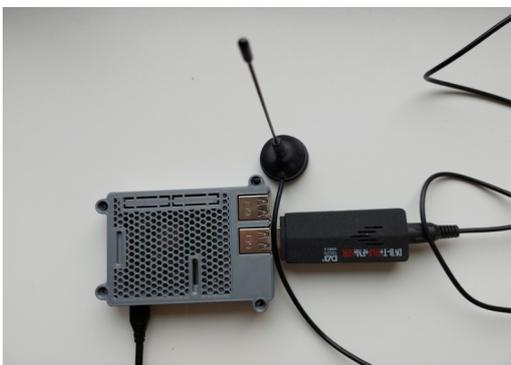
Im Schaubild 7 ist der Aufbau für den Empfang auf 433MHz gezeigt. Es ist recht einfach aus einem Raspberry Pi, einer Antenne und einem passenden USB-Dongle aufgebaut. Auch die Software ist für einen Linux-Nutzer leicht nutzbar.
