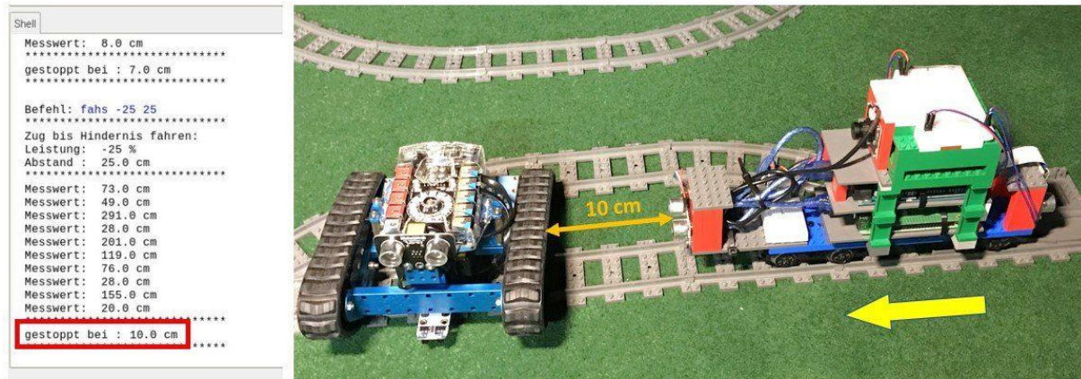
Abbildung 5: Beispiel-Protokoll einer Sensor-gesteuerten Fahrt, bei der ein Hindernis auf den Schienen detektiert und rechtzeitig gestoppt wird.
