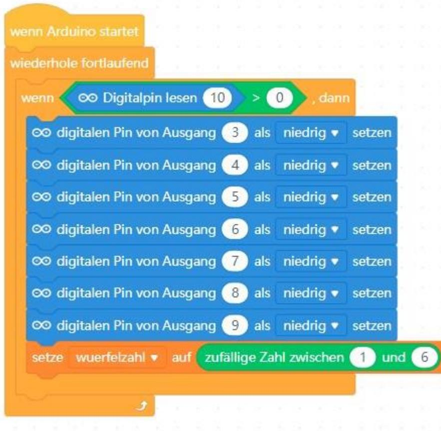
In der Variable „wuerfelzahl“ wird die Zahl gespeichert, die durch Aufleuchten der entsprechenden LEDs gezeigt werden soll. Um diese zu erstellen, einfach auf „Variablen“ > „neue Variable“ klicken und diese benennen.
