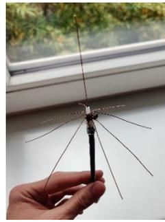
Abb. 5: Antennen-Eigenbau
